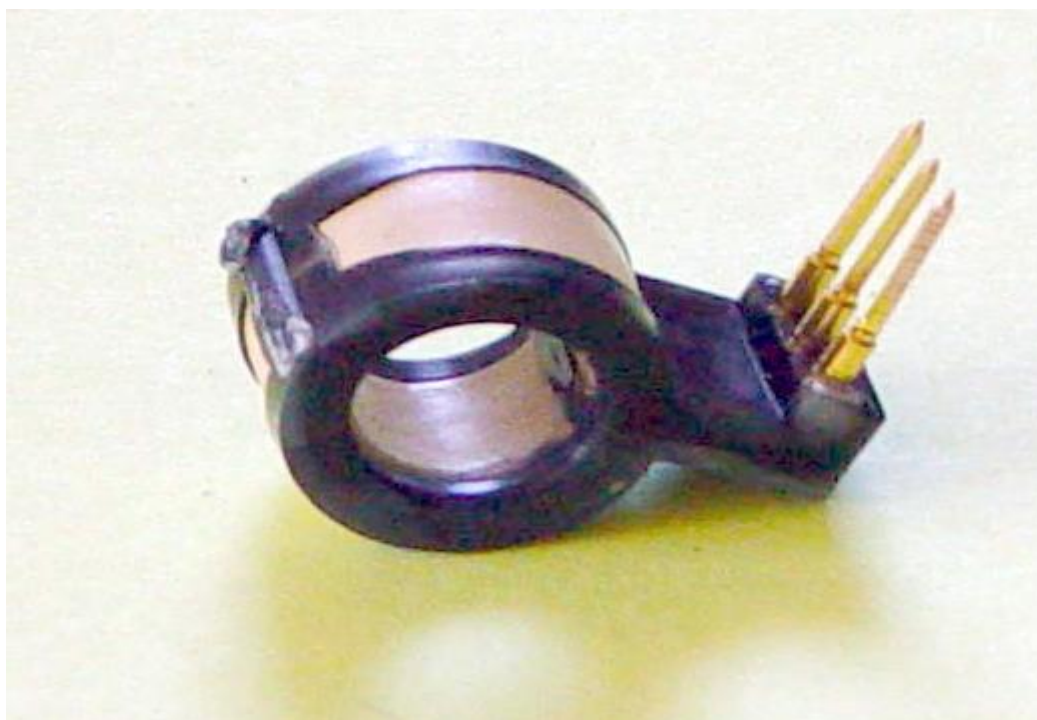
Hình 1.5: Đầu đo dòng điện dùng hiệu ứng Hall (8mm)
